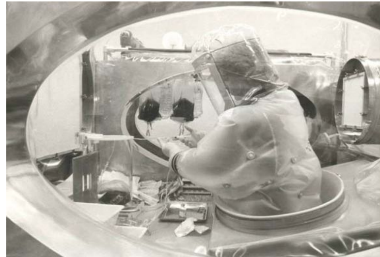
Isolatore principale a semiscafandro con SAS laterali
